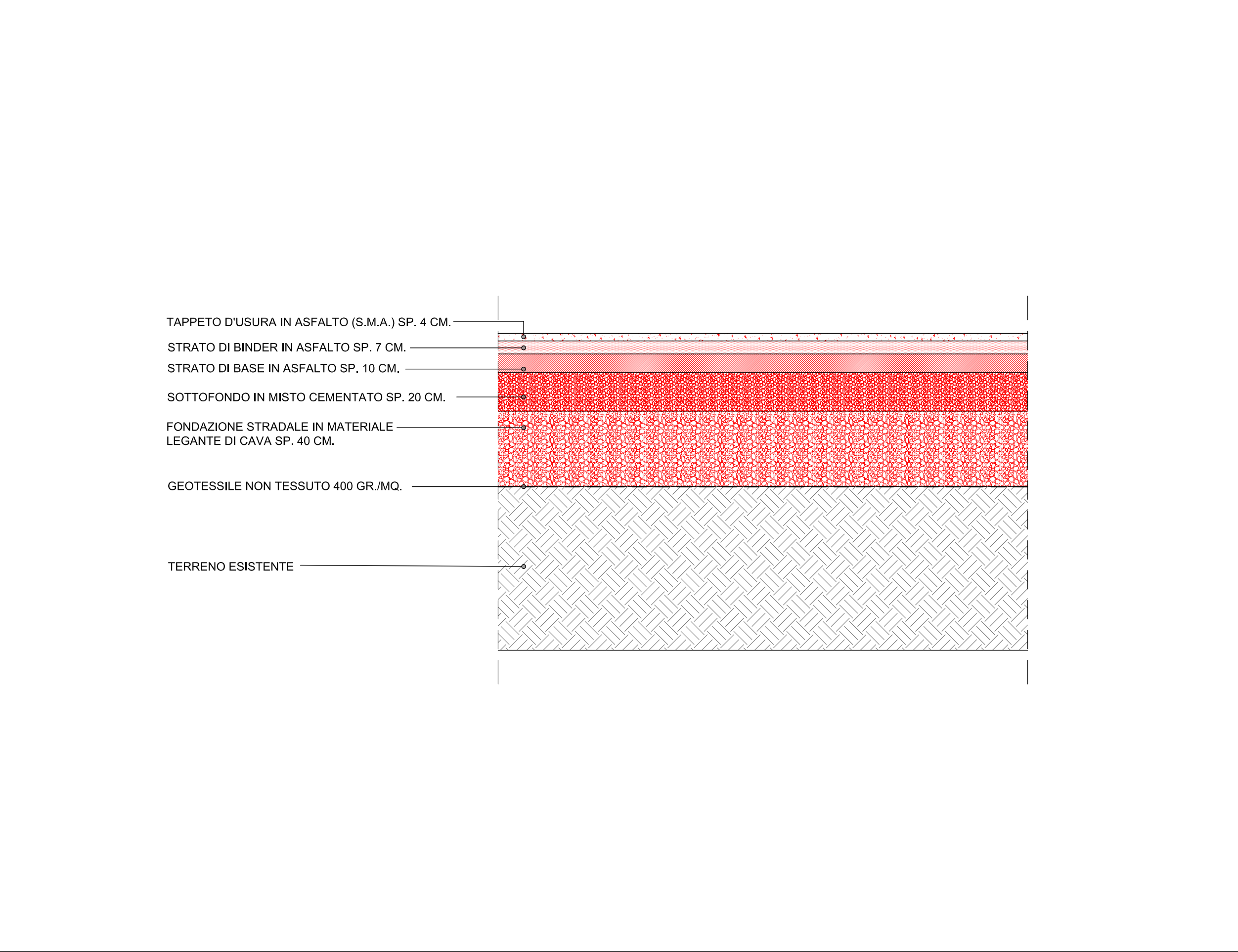
PARTICOLARE STRATIGRAFIA PACCHETTO STRADALE DI PROGETTO - scala 1:20
